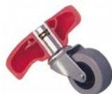
92132 RUEDA ENCAJABLE PARA CAMILLAS PLÁSTICAS. 2" Rueda de uretano, resiste corrosión. Anillo de metal comprime el tronco de la rueda para mantenerlo en lugar, aun así, lo afloja cuando peso es aplicado. Especificaciones: Rueda: 2" Altura, 2 3/4"
